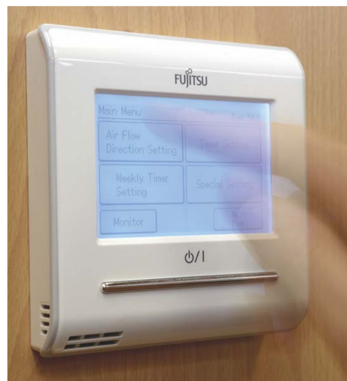
GESTIONE COMFORT. Il pannello/filocomando LCD retroilluminato touchscreen di Fujitsu.
